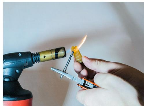
Abbildung 3 - Mit einer Flamme wird der Spitzenkleber erhitzt und im zähflüssigen Zustand am Schaft der Spitze aufgetragen.
