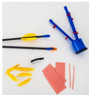
Abbildung 5 - Das Zubehör zum Setzen der Fahnen. Oben rechts der Tri-Liner, am unteren Pfeil ein Nockadapter für asymmetrische Nocken (hier orange), unten Fahnen und Klebestreifen.
